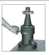
**②**ツールセッティングスタンドに 差し込みナットを締める。
