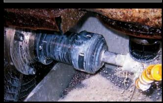
本製品の剛性は高く、ワークセッターとしても有効です。 写真は実際に精密機械加工に使用されているものです。 ※機械の仕様によっては追加工が必要な場合があります。
