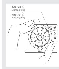
ダイヤル外周部に補助リングを 設けました。これを手動で回転さ せることにより寸法調整が楽にな ると共に読み取りミスがなくなり
